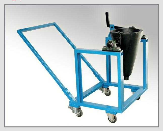
Gruppi di colata serie GC con staffe coniche modello ME/2 - ME/3 - ME/35 - ME/4 Da utilizzarsi in abbinamento ai nostri forni fusori ribaltabili serie ROL. Casting group GC model linked with the conical flasks ME/2 - ME/3 - ME/35 - ME/4 For our tilting furnaces Rol.
